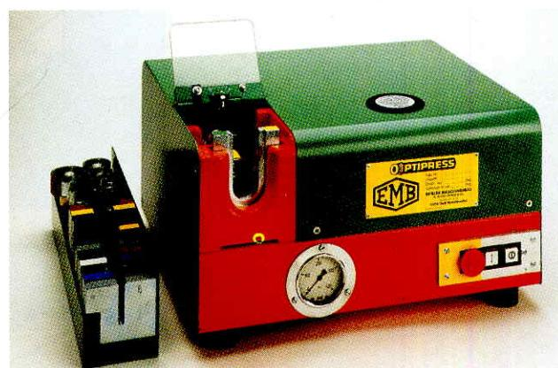
Рис. 222: Станок для предварительной установки врезных колец
