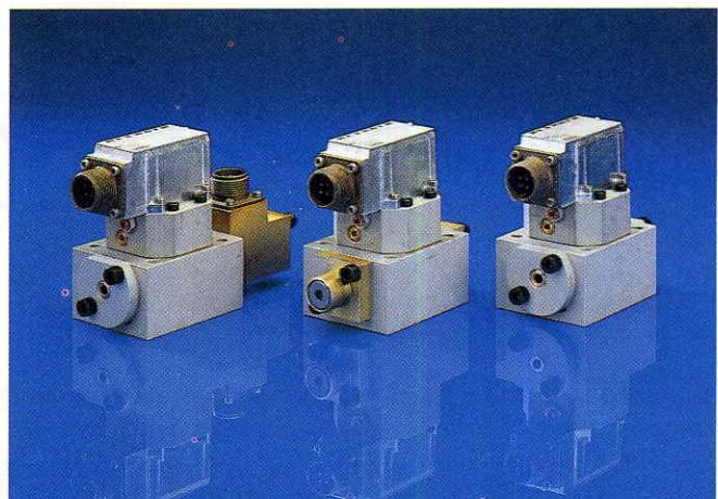
Рис. 2: Сервораспределители ДУ10 с механической обратной связью типа 4WS2EM10 (справа), с электрической обратной связью типа 4WS2EE10 (слева) и барометрической обратной связью типа 4WS2EB10 (посредине)
