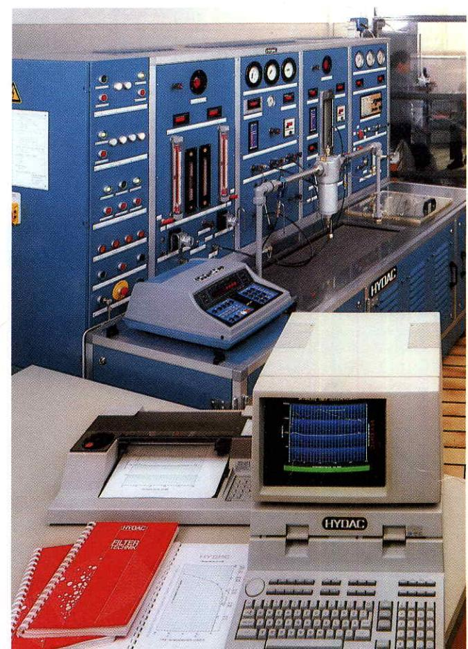
Рис. 7: Multipas - испытание согласно стандарту ISO 4572
