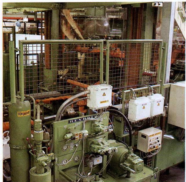
Рис. 3: Требуемое для процесса ускорения 460л/мин. маслопод давлением поставляет аккумуляторный блок, размещенный слева. Пластинчатый насос типа V4, расположенный справа, заполняет аккумулятор во время "неподвижных" фаз.
