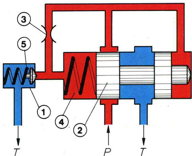
Напорный клапан с предварительным управлением состоит из вспомогательного клапана 1 (клапана предварительного управления) и основного клапана 2. Существующее в системе давление (красный цвет) подается через канал P на правую сторону, через сопло 3 на левую сторону основного поршня и конус клапана предварительного управления. В состоянии покоя на обе стороны поршня действует одинаковое давление. Благодаря тому,
