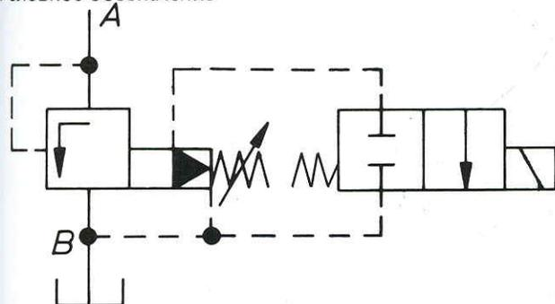
Предохранительный клапан с предварительным управлением тип DB оснащен (2/2-) распределителем.
