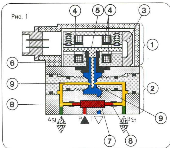
Двухступенчатые распределительные сервоклапаны состоят из первой ступени (электродвигатель 1 и гидроусилитель 2) и второй ступени.
