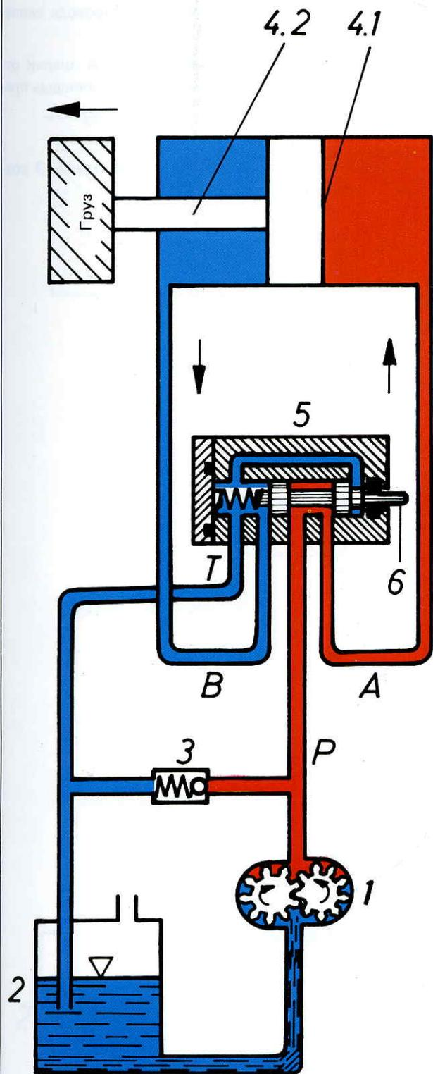
Привод насоса 1 осуществляется электродвигателем или двигателем внутреннего сгорания (рис. 11).
