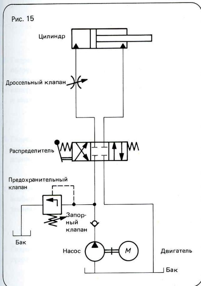
Вместо упрощенных изображений гидравлических систем в разрезе применяют условные обозначения.
