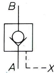
Обеспечивается свободное течение рабочей жидкости в направлении А – В; при течении жидкости в направлении В – А основной конус 1 с конусом предварительного открытия 2 удерживается в гнезде с помощью пружины 3 и давления в гидросистеме (рис. 4).
