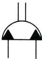
В поворотных гидродвигателях, тип В, крутящий момент возникает за счет поворота выходного звена на определенный угол.
