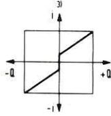
**HSR** Зависим. от давл. управл. масла гидравлич. регулятор с эл.-гидравл. сервоуправлением и электрической обратной связью.
