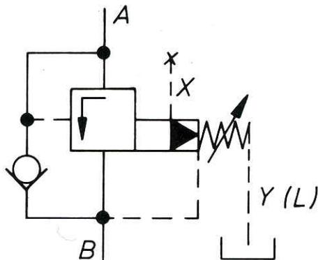
На рисунке изображен клапан подключения давления, применяемый в качестве следящего клапана.
