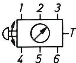
В селекторном переключателе этого типа в ручку регулятора встроен манометр 2 на глицириновой подушке. Шесть точек подключения М расположены по всей поверхности корпуса 3. Поворачивая регулятор и соединенную с ним втулку 4, изображенную на рис. 8, можно соединить каждую точку подключения с манометром.
