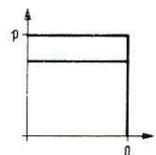
**HM** Зависимый от расхода управляющего масла гидравлический регулятор
