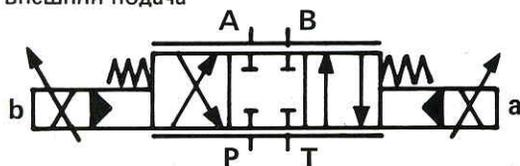
Вспомогательный клапан предварительного управления представляет собой клапан регулирования давления с магнитом пропорционального действия, выполненного в виде регулируемого магнита постоянного тока для масляных сред.
