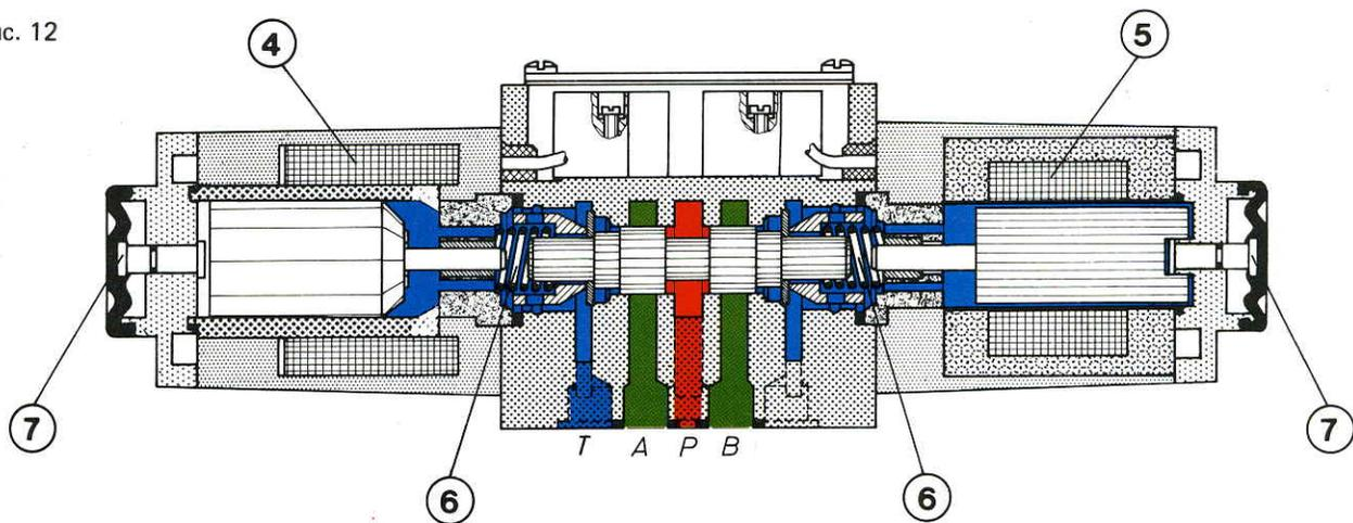
На рисунке 12 изображен магнит постоянного тока 4 (слева) и магнит переменного тока 5 (справа), работающие в масляной среде. Полость якоря обоих магнитов соединена со сливом. На рисунке изображен распределитель с тремя положениями включения.
