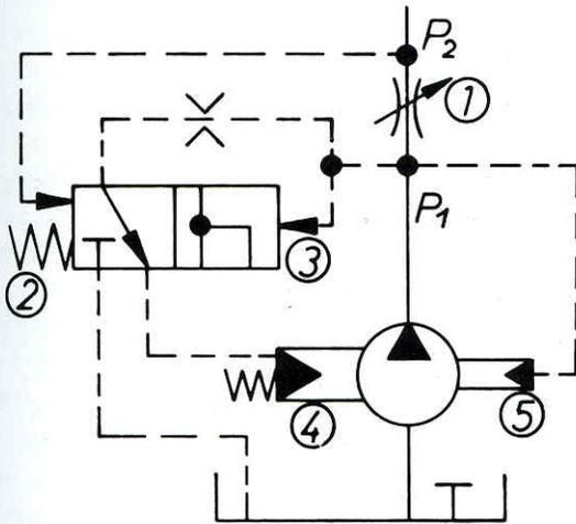
Разность давления ( $p_1 - p_2$ ) в дроссельном клапане 1 трубопровода  $P$  противодействует силе пружины 2. Эта разность действует на поршень регулирующего клапана 3. Регулировочный поршень работает по принципу компенсации давления поточного клапана (см. главу "Поточные клапаны"). Он выдерживает разность давления в пределах от 6 до 8 бар в соответствии с силой пружины.
