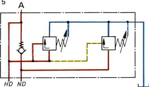
Теперь рабочую жидкость в гидросистему подают только насос высокого давления. Потребитель движется с малой скоростью. Давление в гидросистеме повышается до рабочего. Клапан 2 обеспечивает максимальное рабочее давление и, следовательно, защиту контура высокого давления. Когда максимальное давление достигнуто, клапан 2 открывает канал магистрали слива в бак.
