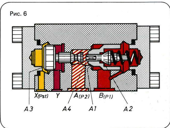
На рисунке изображен разрез клапана тип SL, с присоединением для утечек и конусом предварительного открытия
