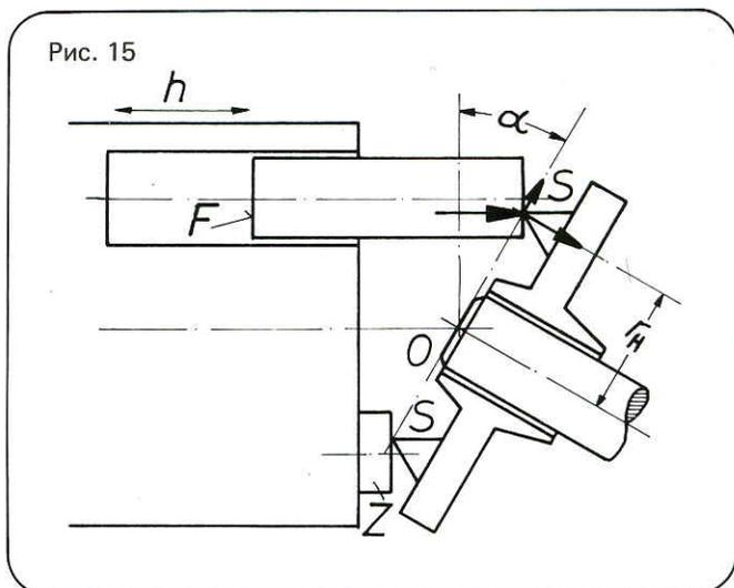
*Аксиально-поршневые насосы и двигатели с наклонной шайбой: регулируемые и нерегулируемые (внизу)*
