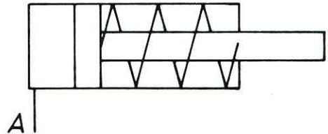
Цилиндр гидравлически выдвигается. Возврат поршня производится с помощью пружины.
