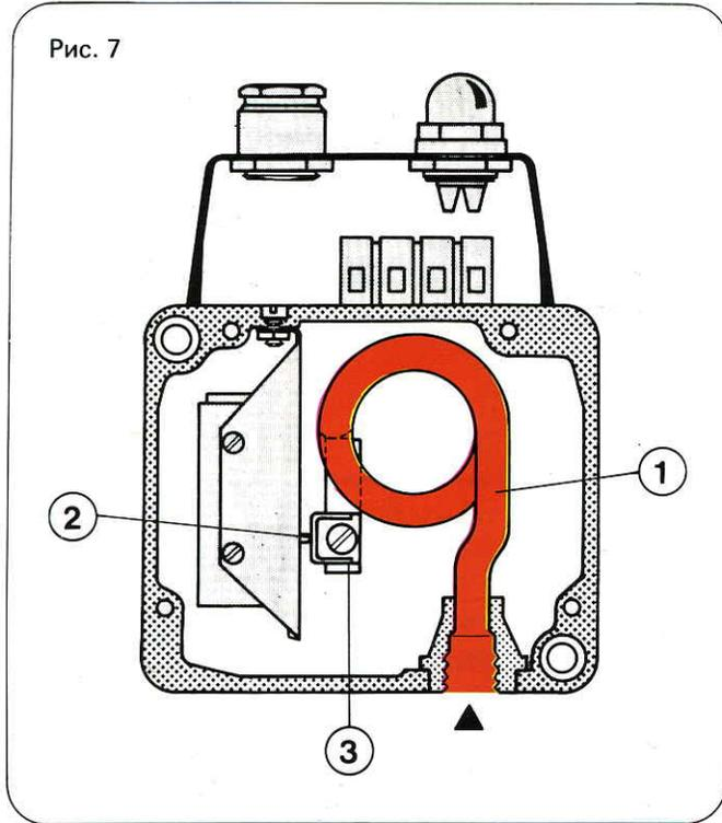
Реле давления с трубчатой пружиной тип HED 2
