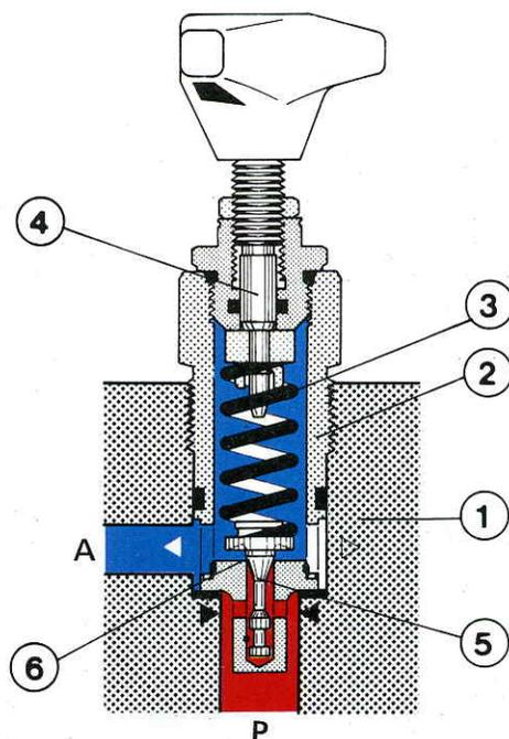
*Ввинчиваемый предохранительный клапан с прямым управлением, тип DBD*
