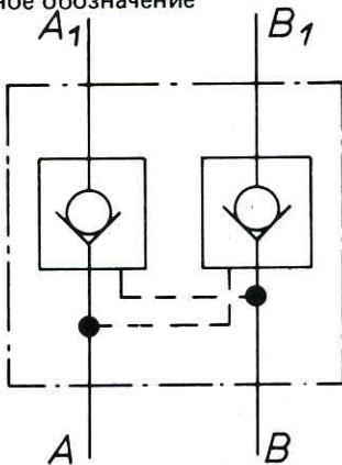
В направлении  $A - A_1$  и  $B - B_1$  рабочая жидкость течет свободно, в направлении  $A_1 - A$  и  $B_1 - B$  проточный канал перекрыт. Если клапан открыт в направлении  $A - A_1$ , то распределительный поршень 3 движется вправо, выталкивая конус обратного клапана 2 из седла.
