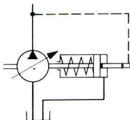
Регулятор мощности с непосредственным управлением устанавливается на задней стороне аксиально-поршневой машины 1 с помощью фланца. Он состоит из пружины 2, на которую действует находящийся под давлением поршень 3. Пружина отжимает наклонную шайбу 4 в направлении большего потока жидкости.
