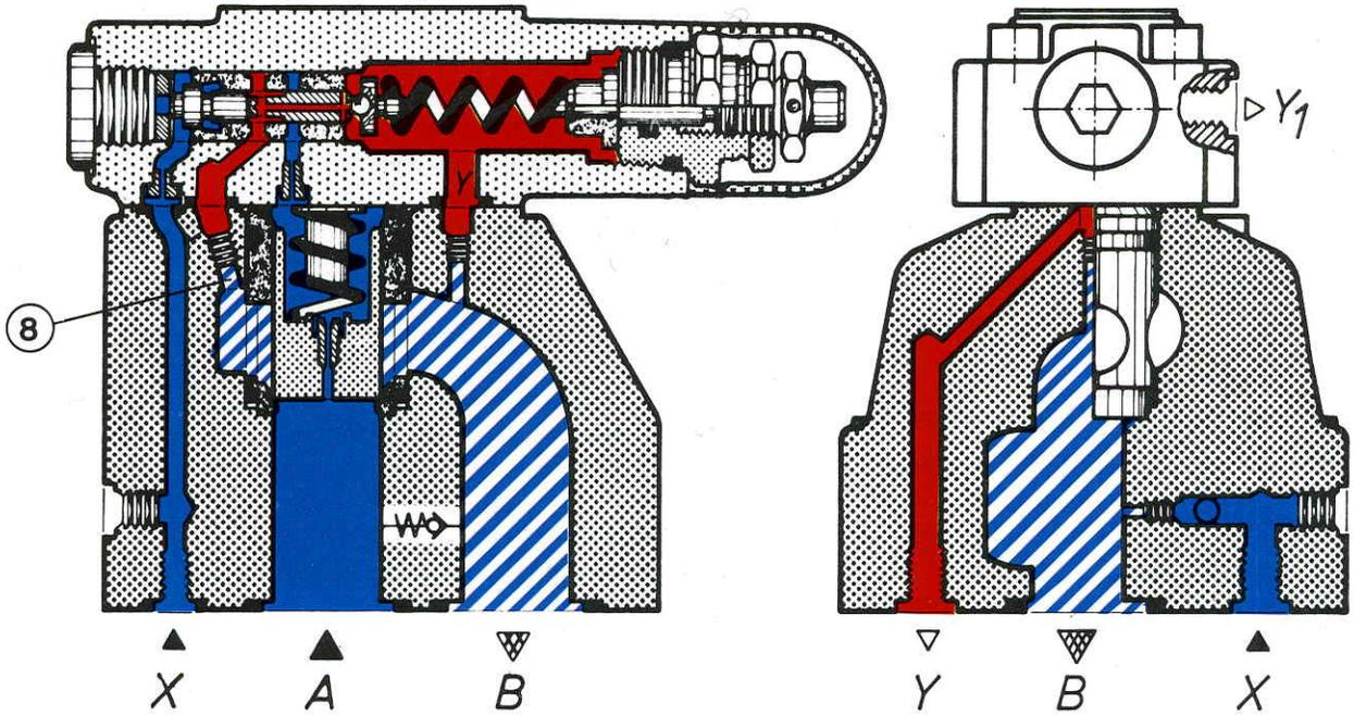
Клапан подключения давления тип DZ, применяемый в качестве циркуляционного клапана
