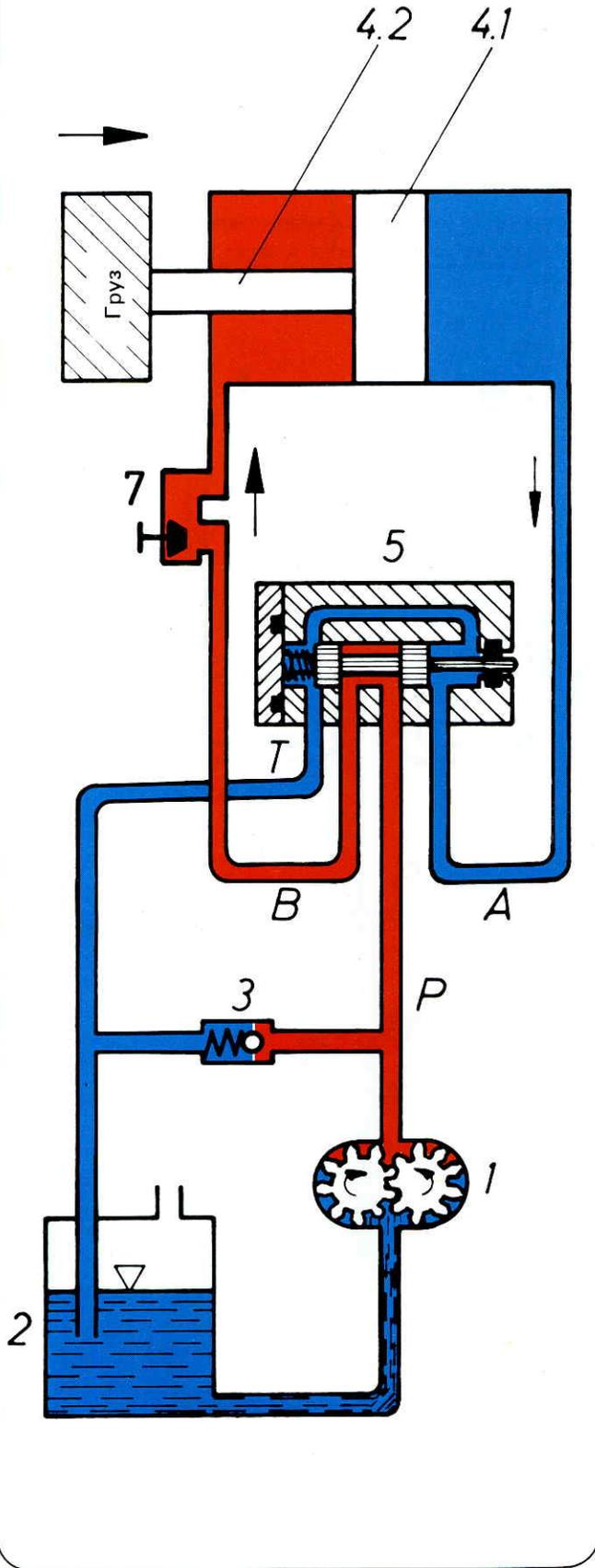
Для того, чтобы регулировать не только направление, но и скорость движения груза, необходимо изменить объем циркулирующей в цилиндре жидкости. Это достигается с помощью дроссельного клапана (рис. 14).
