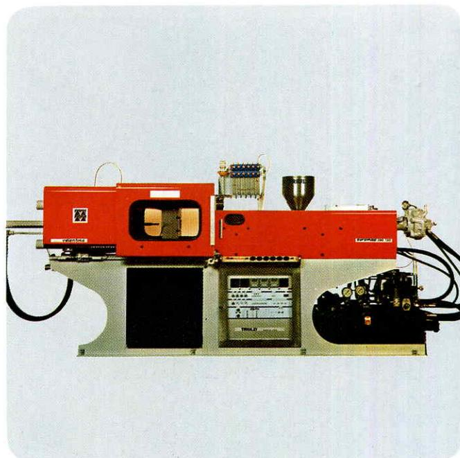
В машинах для литья под давлением в зависимости от габаритов требуется усилие замыкания величиной от 20 до 280 тонн.
