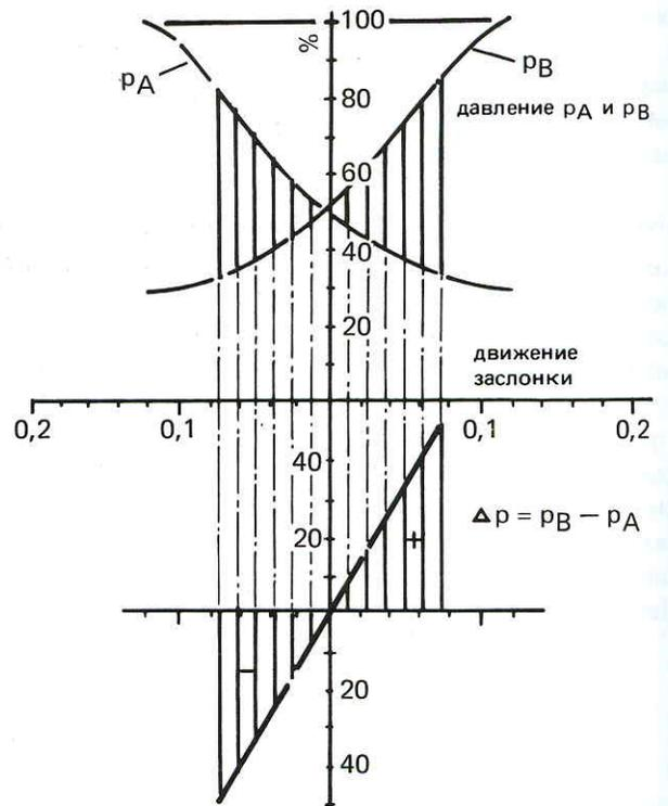
Этот перепад давления передается на поршень управления второй ступени (рис. 4).
