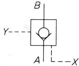
В отличие от клапана тип SV этот клапан имеет дополнительное присоединение для утечек Y. При этом кольцевая поверхность распределительного клапана отделена от точки подключения А. Давление, существующее в точке подключения А, действует только на поверхность  $A_4$  распределительного поршня (рис. 6).
