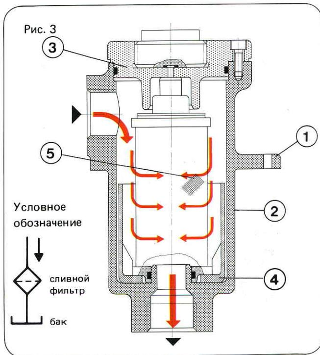
Фильтр устанавливается непосредственно в резервуарах (рис. 3) или перед ними в магистрали.
