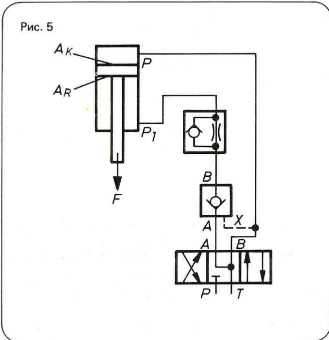
На принципиальной схеме показано, что в точке подключения А при применении гидравлической деблокировки давления не должно быть. Давление в точке А противодействовало бы регулируемому давлению распределительного поршня.
