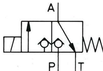
В двухшаровом клапане, находящемся в исходном положении, канал A – T открыт, а точка подключения P закрыта. Пружина и рабочее давление удерживают шар в гнезде канала P. При переключении правый шар выходит из гнезда, а левый входит в гнездо.
