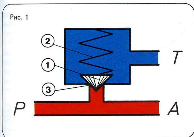
Затвор 1 прижимается к гнезду 3 пружиной 2. Усилие, с которым затвор прижимается к гнезду, соответствует размеру и силе предварительного натяжения пружины. Полость пружины в направлении бака разгружена. Да-
