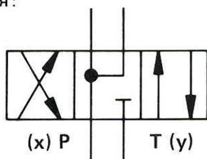
Если включить правый магнит распределителя, то поршень предварительного управления движется влево. Полость 6 по-прежнему соединена с магистралью давления управления, а полость 7 разгружена в направлении бака. Центрирующая втулка 8 прилегает к корпусу, а центрирующий винт 9 передвигает основной поршень вправо до упора.
