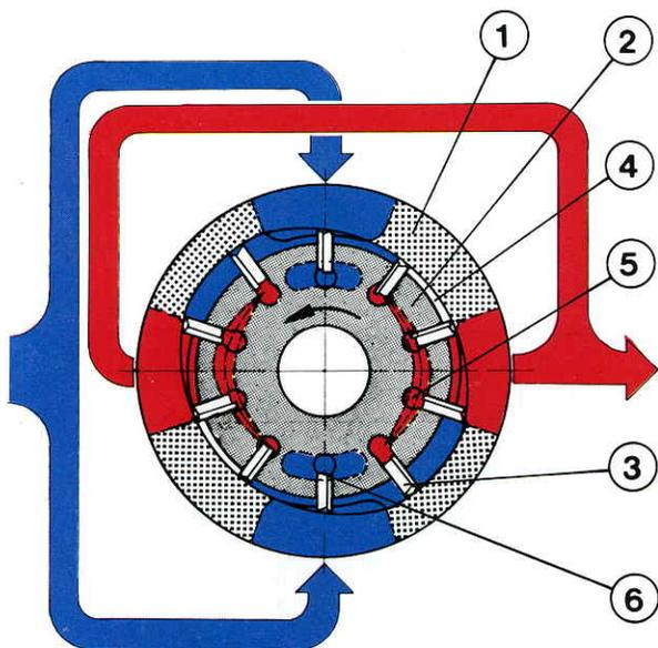
Роторно-пластинчатый насос состоит из корпуса, статора 1 и ротора 2 с лопастями 3.
