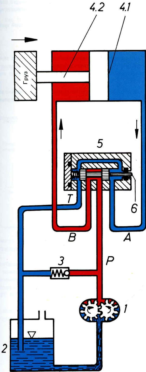
Ходом поршня 4.1, приводимого в движение поршневым штоком 4.2, управляет клапан 5 (распределитель), рис.13.
