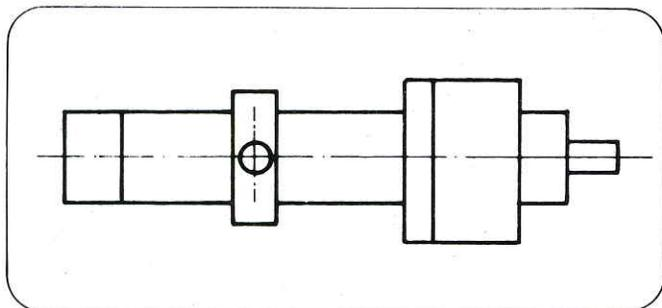
Для установки в горизонтальном и вертикальном положении. Поворотная цапфа может передвигаться. Цапфа, установленная в середине трубы, обеспечивает оптимальное положение центра тяжести.
