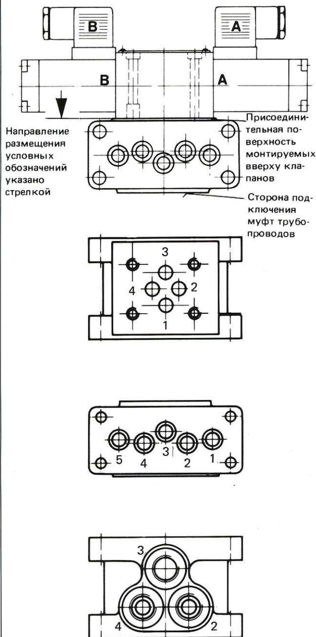
Изображение блока горизонтального сцепления отличается от обычных изображений принципиальных схем (рис. 3).
