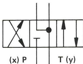
Через магистраль управления 5 в распределитель предварительного управления подается рабочая жидкость. Подача рабочей жидкости может производиться *изнутри* и *извне* (подробнее см. стр. 107).
