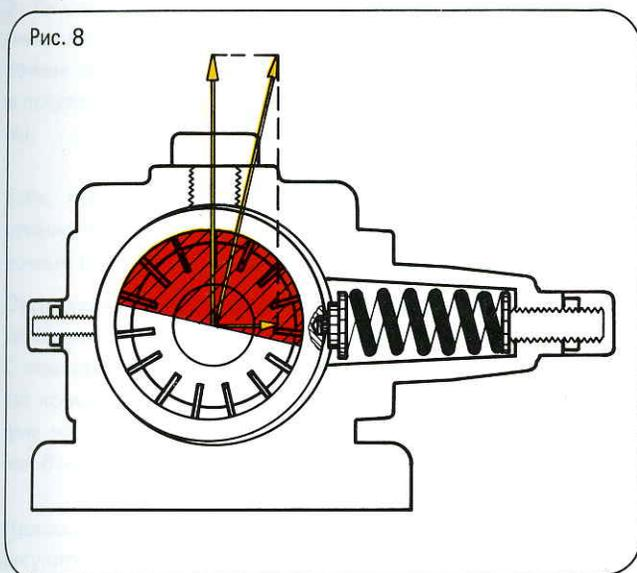
По достижении силы давления, равной установленной силе пружины, кольцо статора из эксцентриситета возвращается в нулевое положение. Эксцентриситет уменьшается.
