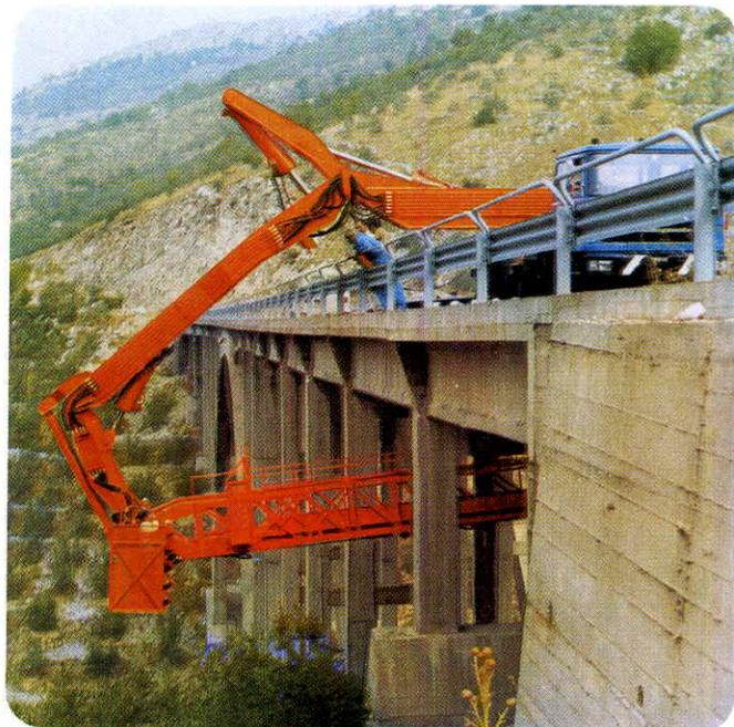
В строительстве применяется множество различных машин, открывающих новые возможности гидравлики. Об этом наглядно свидетельствует эта фотография с изображением машины для контроля за состоянием мостов.
