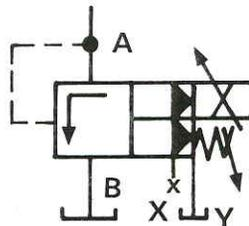
Предохранительный клапан тип DBE с предварительным управлением и блоком предельного давления.
