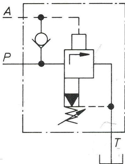
Клапаны отключения давления тип DA применяются в гидросистемах с гидроаккумуляторами давления. Они состоят из вспомогательного клапана предварительного управления 1, основного клапана 2 и обратного клапана 3 (рис. 12).
