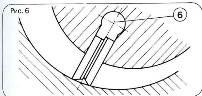
Скошенные углы позволяют выровнять давление между рабочей и обратной стороной лопасти. В качестве прижимной поверхности используется рабочая поверхность лопастей. На стороне всасывания большой прижимной силы не требуется. Поэтому обратные стороны 6 лопастей разгружены.
