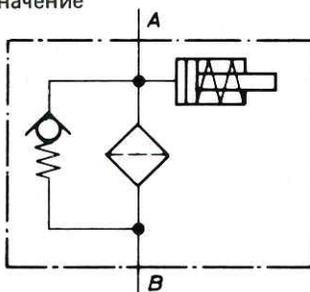
Фильтр с оптическим (механическим) индикатором загрязнения.
