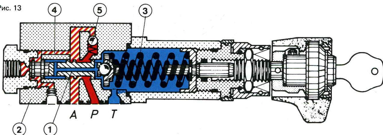
Редукционный клапан тип DR 6 D в разрезе
