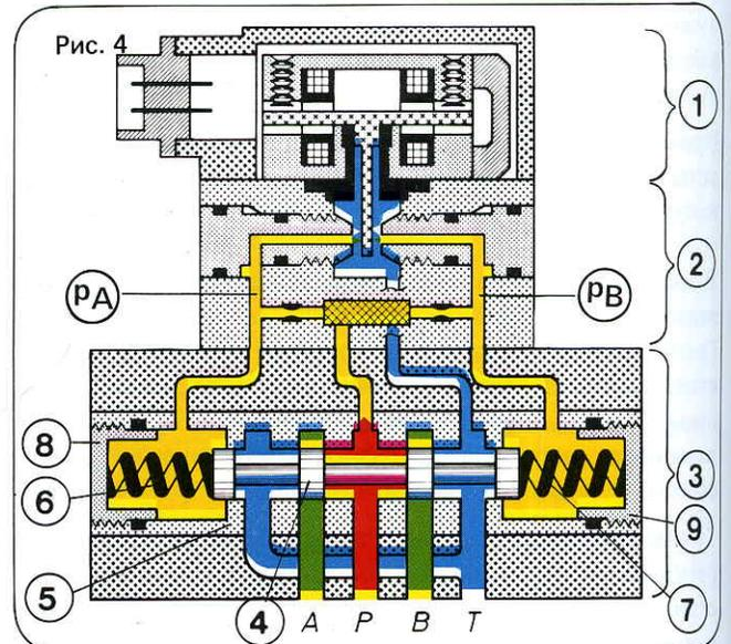
Двухступенчатый сервоклапан с центрирующими пружинами (барометрическая обратная связь).
