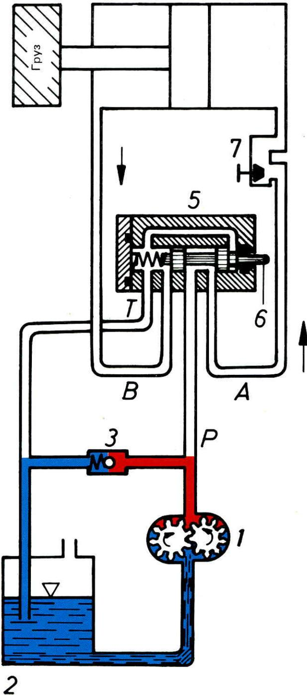
Чтобы предохранить систему от перегрузки (то есть от избытка давления), максимальное давление должно быть ограничено.
