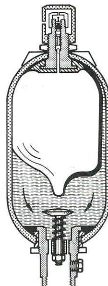
При отборе рабочей жидкости эластичная камера снова увеличивается в размерах (рис. 5). Давление газа и, следовательно, давление в гидроаккумуляторе соответствует закону течения газов:
