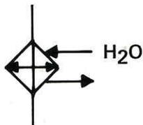
В змеевиках этих радиаторов находится вода или рабочая жидкость. В зависимости от этого вокруг змеевиков циркулирует соответствующая среда (вода, рабочая жидкость).
