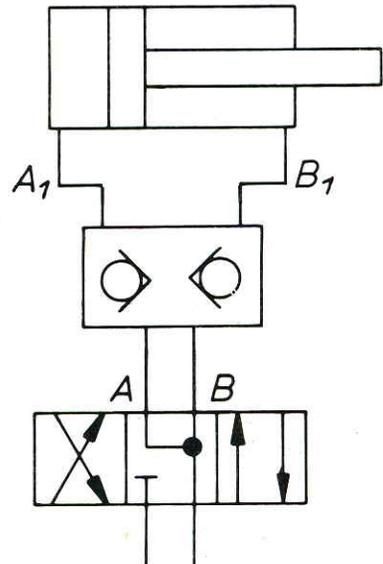
Обе точки подключения цилиндра перекрыты без утечки. При заданной остановке цилиндра (в любом положении) его невозможно сдвинуть даже с помощью усилия извне. Т.е. находящийся под нагрузкой цилиндр не "ползет" даже при остановке в течение длительного времени.
