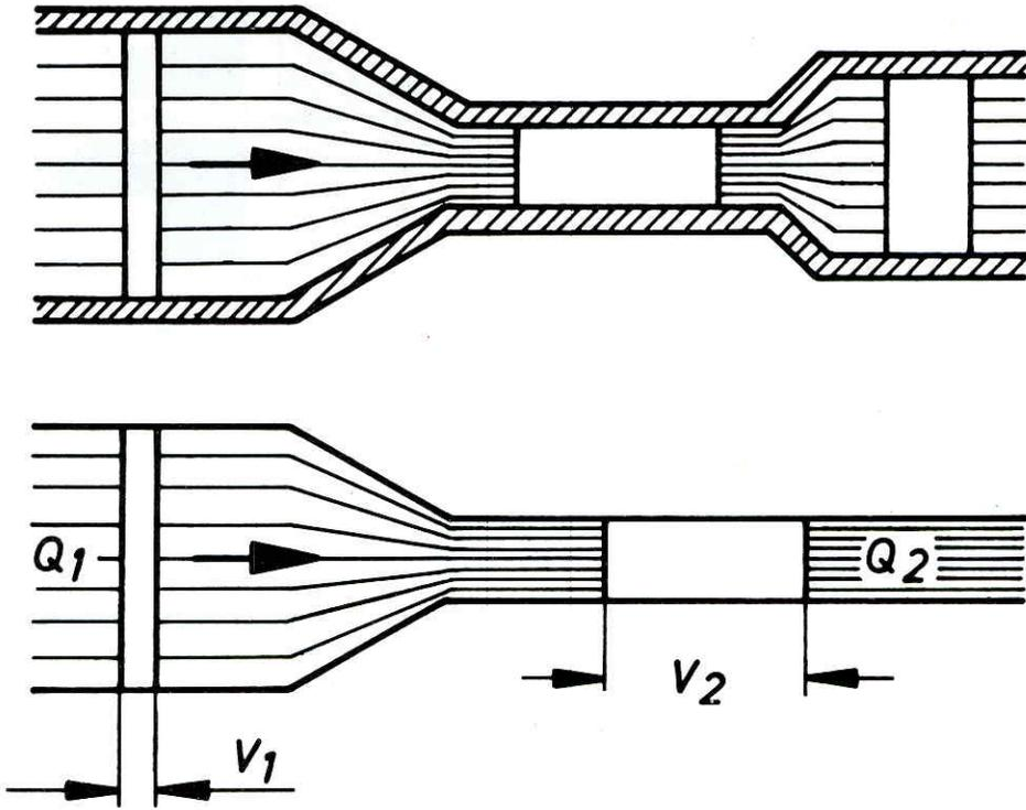
Если жидкость течет через трубу с меняющимся сечением, то количество жидкости, протекающей за равные промежутки времени, одинаково (рис. 5). Скорость объемного расхода меняется.
