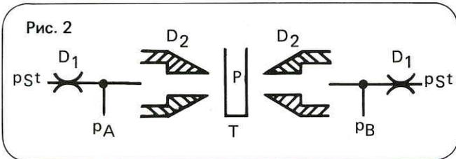
ния). Поскольку сопла имеют одинаковое сечение, то давление над соплами падает одинаково (например,  $p_{st} = 100$  бар,  $p_A = 50$  бар,  $T = 0$ ).
