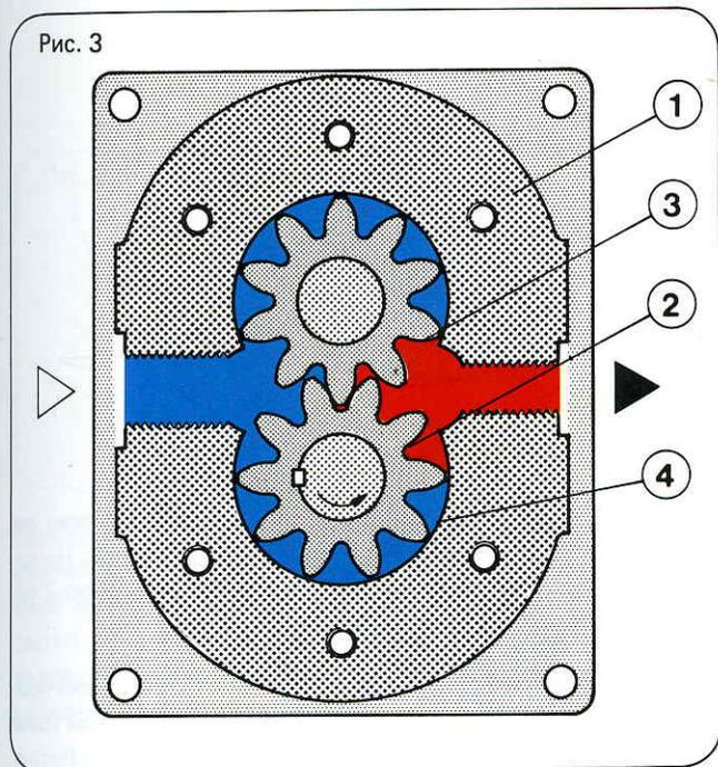
В этом насосе зубья шестерней поступают во внешнее зацепление. Шестерня 2 движется в направлении стрелки и захватывает шестерню 3, которая вращает ее в противоположном направлении. Процесс всасывания происходит точно также, как и в насосе с внутренним зацеплением.
