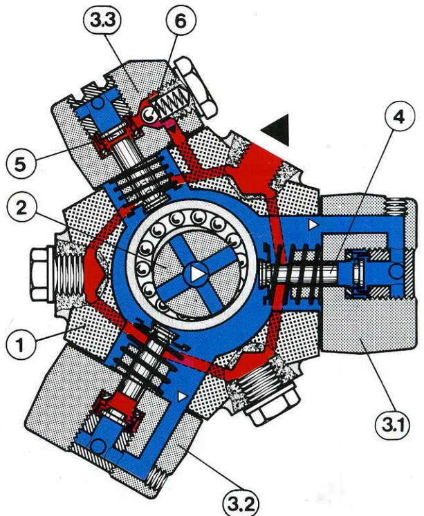
Под элементом насоса следует понимать действующий однопоршневой насос, привинченный к корпусу. Поршни находятся в элементах и прижимаются к эксцентриковому валу пружинами.
