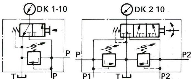
Устройство для контроля давления тип DK представляет собой сочетание приборов и служит для ограничения и индикации давления в одной (тип DK1) или двух гидросистемах (тип DK2).
