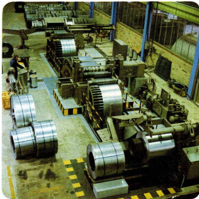
Полностью автоматическое устройство для резки стальной ленты, предназначенной для производства щитов трансформаторов.
