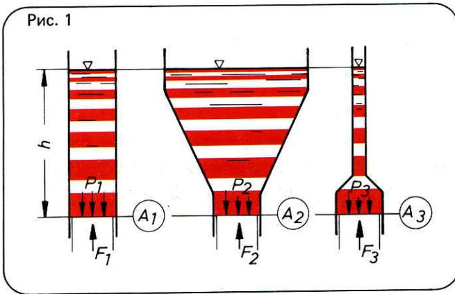
Если рассматривать различные формы сосудов, наполненных однородной жидкостью, то давление в какой-то определенной точке будет зависеть только от высоты столба жидкости:
