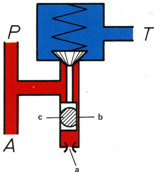
На рисунке изображены действующие силы, т.е. статическая сторона клапана. С динамической точки зрения мы имеем дело с системой пружина – масса, которая, двигаясь, совершает колебания. Эти колебания влияют на давление. Их необходимо устранить с помощью демпфера.
