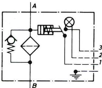
Фильтр с оптическим электроиндикатором загрязнения
