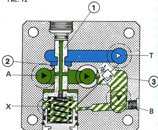
Регулирующий поршень 1 расположен в клапане таким образом, что излишек поступающей из насоса рабочей жидкости сливается через распределительную кромку 2 непосредственно в бак.
