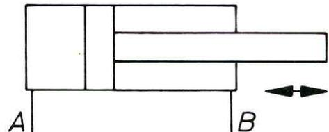
По мере поступления рабочей жидкости через точку подключения А шток выдвигается, а при поступлении рабочей жидкости через точку В — втягивается. Максимальное усилие зависит от эффективных поверхностей поршня (при выдвигении), площади сечения кольца (при втягивании) и максимально допустимого рабочего давления. Т.е. усилие при выдвигении больше усилия при втягивании поршня.
