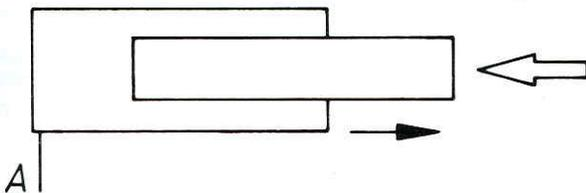
Рабочая жидкость под давлением подается через точку подключения А, действуя на поршень. Поршень выдвигается (→).
