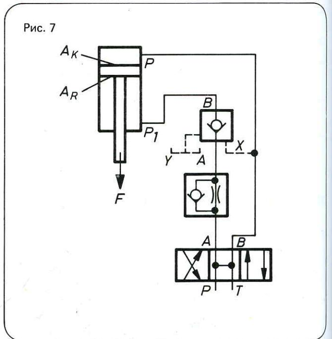
На принципиальной схеме видно, что при гидравлической деблокировке предварительное напряжение рабочей жидкости в точке подключения А осуществляется с помощью дроссельного клапана (рис. 7).
