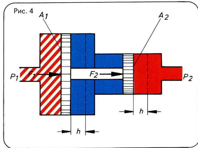
Два поршня различных размеров соединены друг с другом поршневым штоком.
