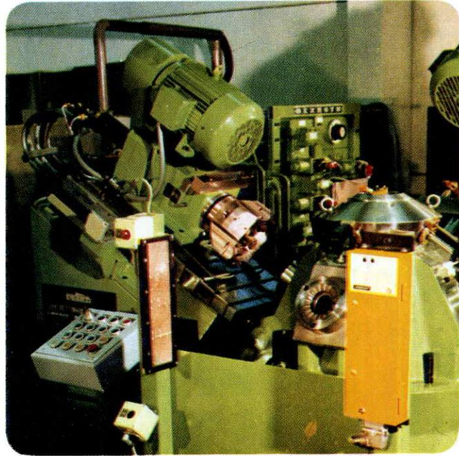
Четырехпозиционный двухходовой шлифовальный станок с круглым столом для окончательной обработки шестеренок, изготовленных способом холодного прессования.
