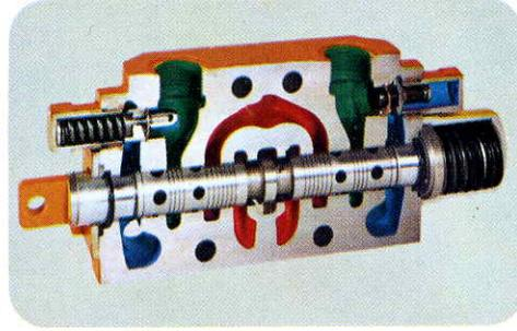
Звено распределителя секционного управляющего блока (от Ду 10 до 22)
