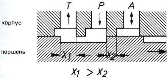
При переключении канал потребителя (точка подключения А) открывается раньше, чем закрывается канал бака. Таким образом, в момент переключения все точки соединены друг с другом. Возникает необходимость во вторичном переключении. В этом случае при определенных нагрузках цилиндр может прийти в движение, что нежелательно.
