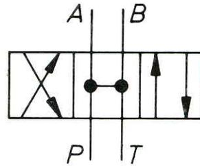
Маркировка точек подключения всегда производится в исходном положении.
