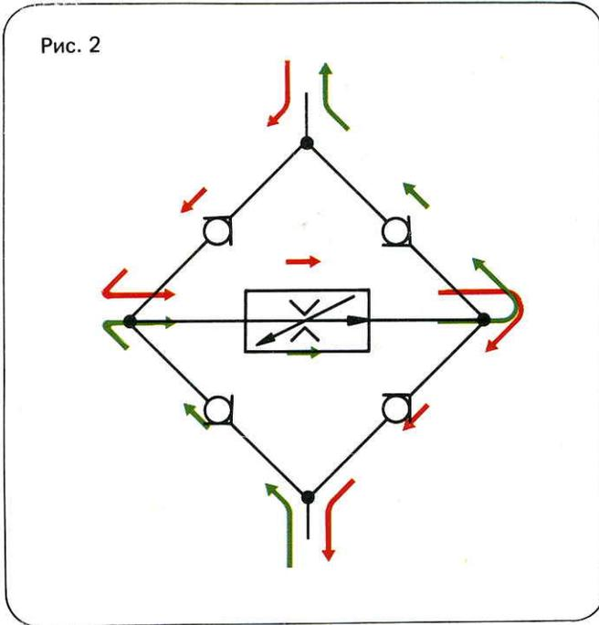
Разрез выпрямительной плиты, тип Z4S,
