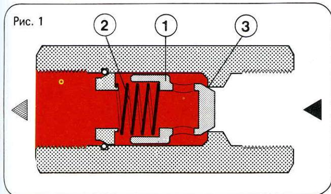
На рисунке изображен простой обратный клапан в разрезе (см. фотографию) с конусным затвором 1, который удерживается пружиной 2 в гнезде 3 корпуса. Этот клапан может устанавливаться в любом положении, поскольку пружина постоянно удерживает конус в гнезде (рис. 1).
