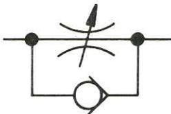
Жидкость, поступающая в направлении дросселирования, подается на обратную сторону 1 конуса 2 обратного клапана. Конус обратного клапана прижимается к гнезду. Дросселирование производится также как и в дроссельном клапане тип MG (рис. 2).
