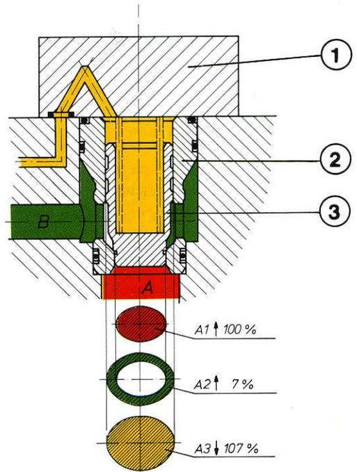
Двухходовые встроенные клапаны, которые нередко называют "логическими элементами", состоят из встроенного блока и крышки 1 с регулирующими проточками. Встроенный блок в свою очередь состоит из втулки 2 с гнездом и затвором 3, который мы будем в дальнейшем называть "конус клапана". Конус клапана удерживается в гнезде с помощью пружины (рис. 11).
