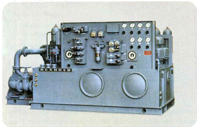
*Приводной агрегат шпиндельного прессы*
