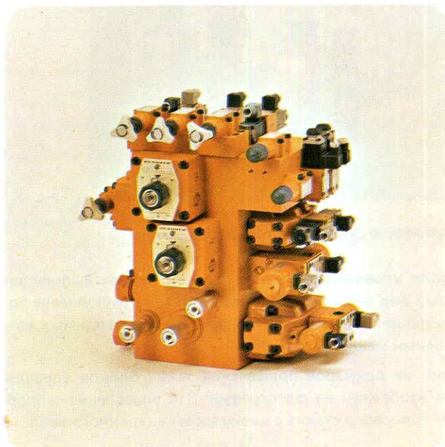
*Блок управления всеми операциями машины пластмассового литья под давлением с вертикально расположенными и винчиваемыми клапанами.*
