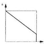
**HD** Зависимый от давления управляющего масла гидравлический регулятор
