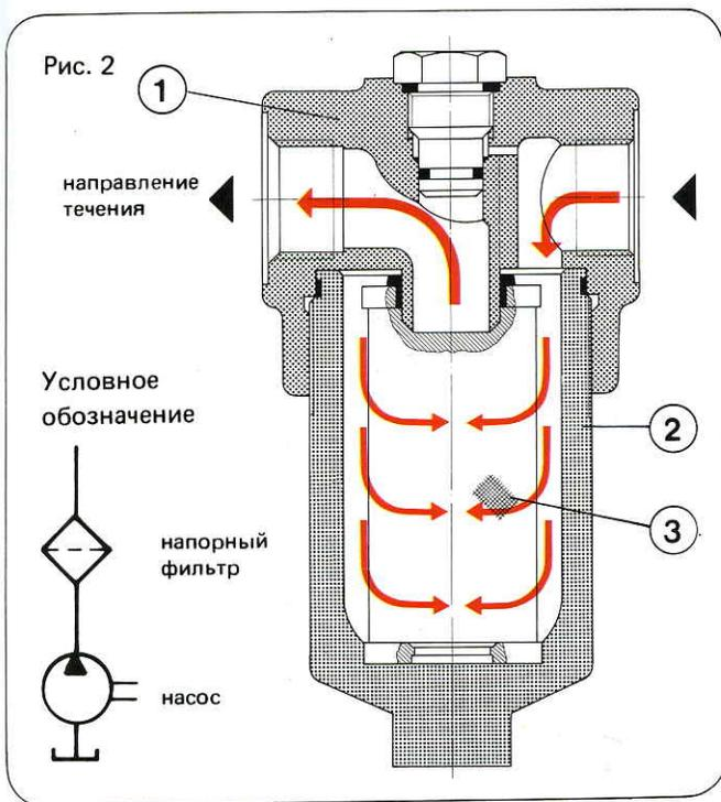
На рисунке 2 изображен напорный фильтр (тип DF), предназначенный для установки в линии нагнетания.
