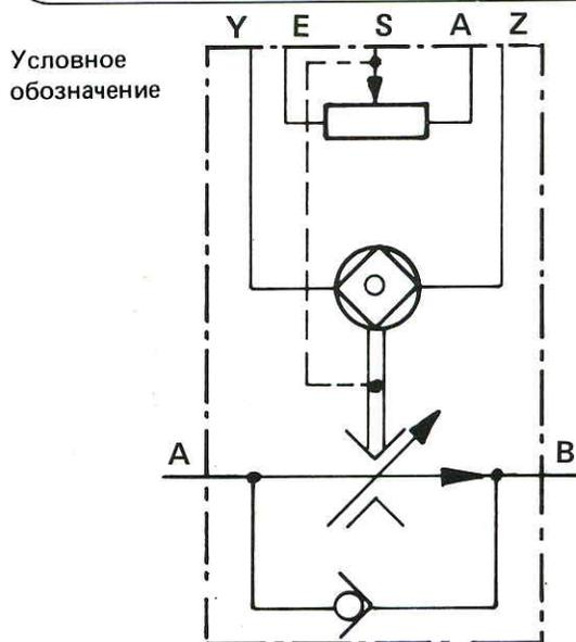
Гидравлическая часть, двухходовой клапан регулирования потока 1, выполнен в виде клапана регулирования потока тип 2FRM (рис. 4) (см. поточные клапаны).
