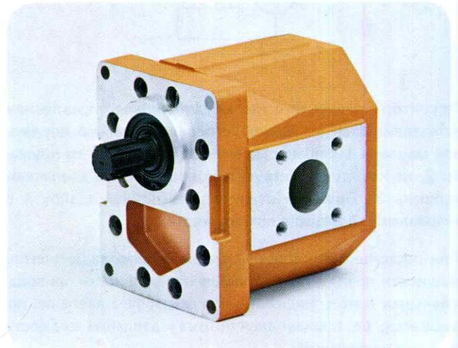
Шестеренные двигатели тип G точно соответствуют шестеренным насосам с внешним зацеплением. В них применен обратный принцип действия. Крутящий момент зависит от рабочего давления и площади зубьев шестерней.
