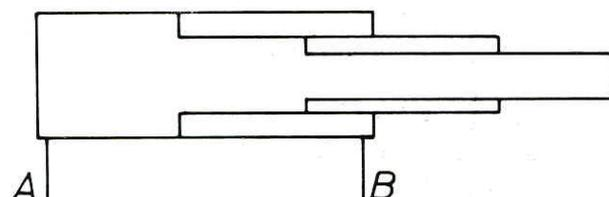
С помощью цилиндров такого типа, занимающих сравнительно мало места, удастся получить большую мощность хода. Установочная высота не намного превышает высоту хода одного поршня.
