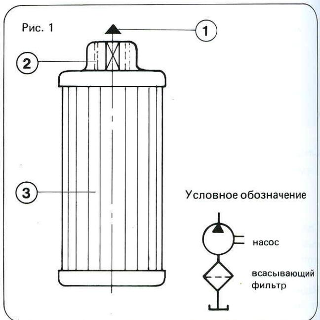
Всасывающие фильтры (рис. 1) устанавливаются во всасывающей магистрали насоса.
