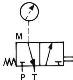
Запорный клапан манометра является трехходовым распределителем с клавишным управлением. Запорный клапан манометра служит для разового контроля рабочего давления.
