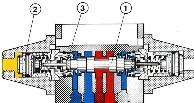
На рисунке изображен чертеж клапана с двумя положениями включения в разрезе (рис. 10).
