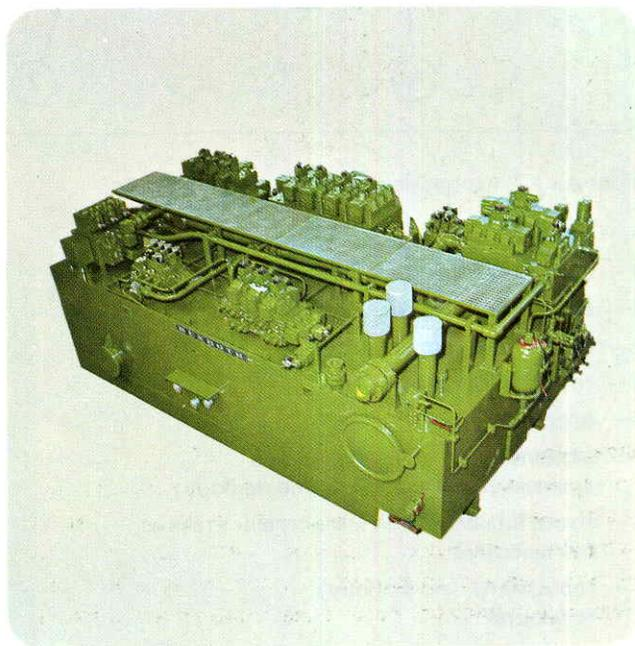
Комплектный привод алюминиевого профильного прес-са мощностью 2500 т.
