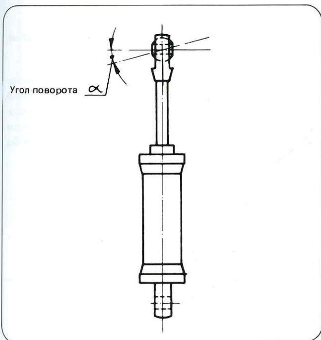
*Оба осевых болта юстируются параллельно друг другу*
