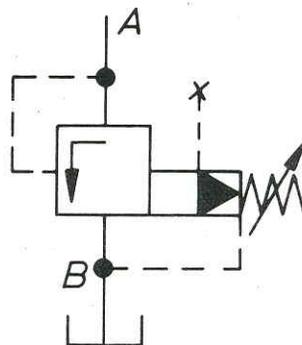
Слив рабочей жидкости из контура управления может производиться наружу или вовнутрь. Следует, однако, учитывать, что при наружном сливе напор, возникающий в сливной магистрали, влияет и на пружину вспомогательного клапана, т.е. давление включения увеличивается на величину напора.
