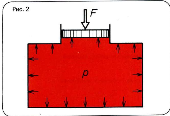
Если на свободную поверхность  $A$  находящейся в замкнутом контуре жидкости (рис. 2) действует сила  $F$ , то в жидкости возникает давление.
