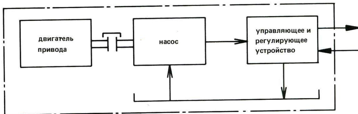
Под гидроагрегатом следует понимать ряд отдельных элементов, образующих одну систему (рис. 1).
