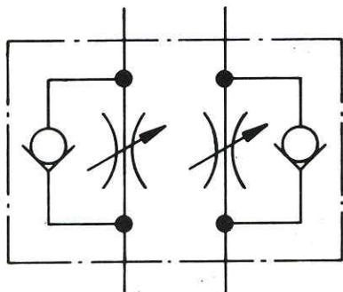
Они применяются для регулирования скорости потребителя (ограничение главного потока) и монтируются между распределителем с прямым управлением и присоединительной плитой.
