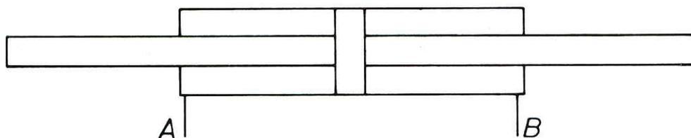
При наличии двухстороннего штока эффективная площадь поршня и его кольца одинаковы. Таким образом, силы и скорости, действующие в обоих направлениях, равны.
