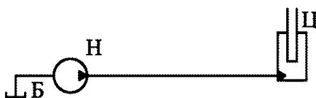
**Рис. 4.5.2. Расчетная схема гидропривода к решению задачи о выборе внутреннего диаметра напорной гидролинии**
