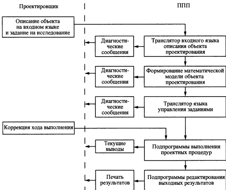
Рис. 6.1.2. Схема взаимодействия проектировщика с пакетом прикладных программ (ППП) в составе САПР
